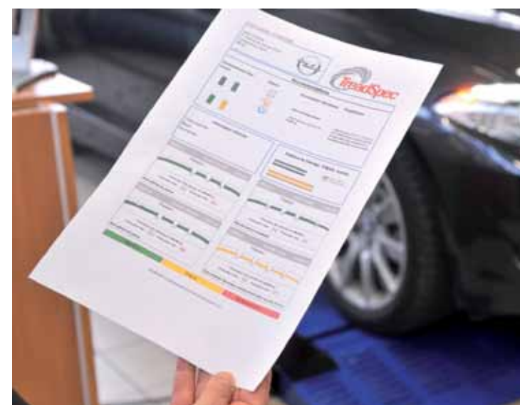
▲ Chaque contrôle donne droit à un rapport imprimé qui peut être présenté au client. Il affiche clairement, schémas très explicites à l'appui, l'usure de chaque pneumatique.
